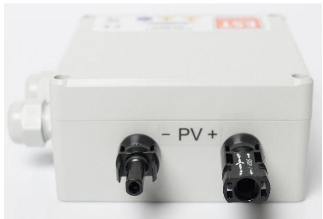
Rys. 8 Widok złącz MC-4 do przyłączenia paneli fotowoltaicznych
